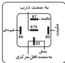
شماتیک تک سیم پراید جدید، کوئیک، ساینا
